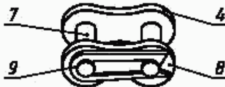
г — соединительное звено с пружинным замком
